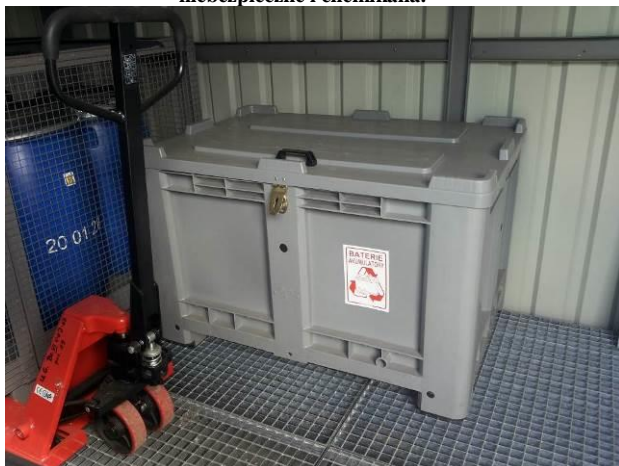
Fot. 9. Wyposażenie kontenera na odpady niebezpieczne – specjalistyczny pojemnik na zużyte akumulatory.
