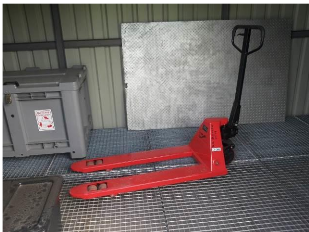
Fot. 11. Wyposażenie kontenera na odpady niebezpieczne – wózek ręczny paletowy „paleciak” z udźwignięm do 2 500 kg wraz z rampą najazdową.
