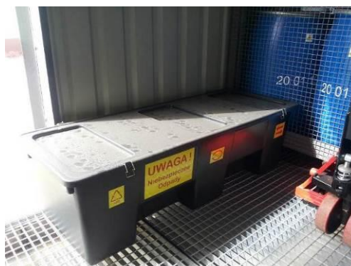
Fot. 14. Wyposażenie kontenera na odpady niebezpieczne – specjalistyczny pojemnik na zużyte świetlówki (źródło: Urząd Miasta i Gminy w Nowej Słupii).
