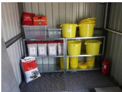
Fot. 11. Wyposażenie kontenera na odpady niebezpieczne - apteczka, koc gaśniczy, gaśnica, sorbent, pojemniki na przeterminowane leki oraz jednorazowe pojemniki na substancje niebezpieczne i chemikalia (źródło: Urząd Miasta i Gminy w Nowej Słupii).
