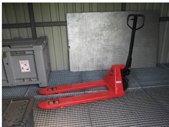
Fot. 15. Wyposażenie kontenera na odpady niebezpieczne – wózek ręczny paletowy „paleciak” z udźwignięm do 2 500 kg wraz z rampą najazdową (źródło: Urząd Miasta i Gminy w Nowej Słupii).
