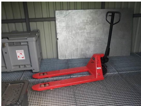
Fot. 11. Wyposażenie kontenera na odpady niebezpieczne – wózek ręczny paletowy „paleciak” z udźwignięm do 2 500 kg wraz z rampą najazdową (fot. M. Jasiak).
