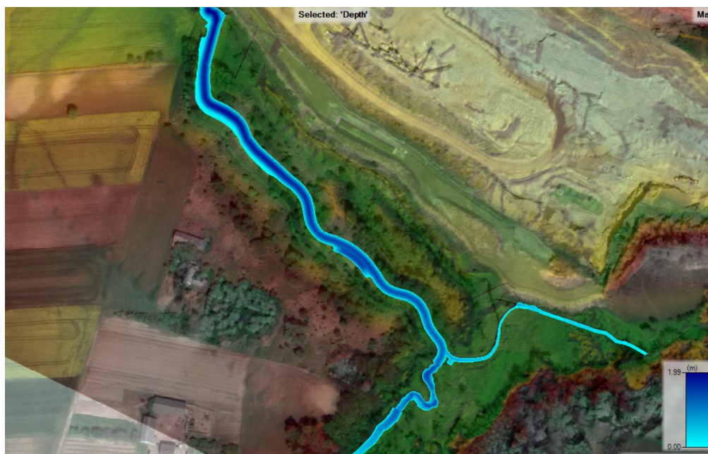
Rysunek 18b Nowe koryto rzeki Dobruchna w fazie odcięcia istniejącego koryta i przepięcia Dopływu spod Czajęcic
