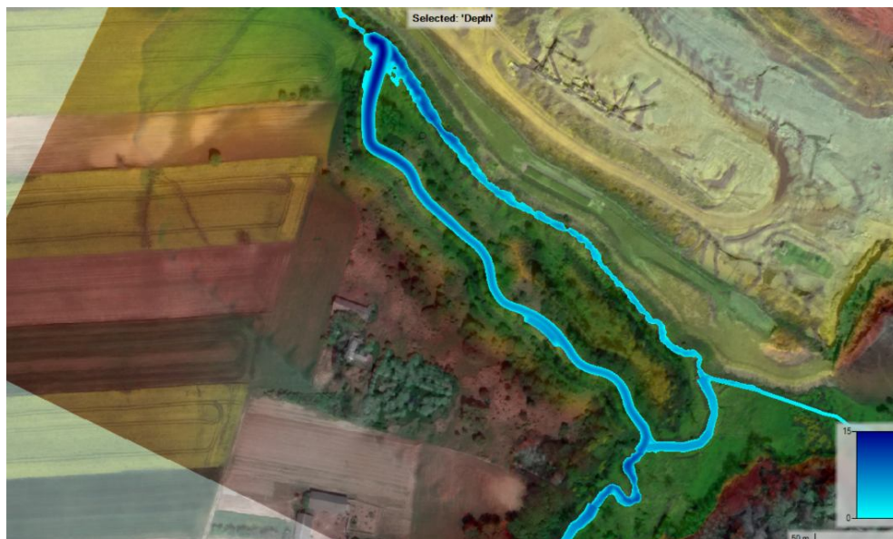
Rysunek 18a. Nowe koryto rzeki Dobruchna i obecne w fazie jednoczesnego funkcjonowania
