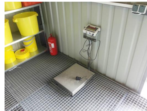
Fot. 6. Wyposażenie kontenera na odpady niebezpieczne - waga z zakresem ważenia do 150 kg.
