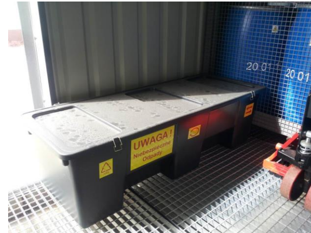
Fot. 10. Wyposażenie kontenera na odpady niebezpieczne – specjalistyczny pojemnik na zużyte świetlówki.
